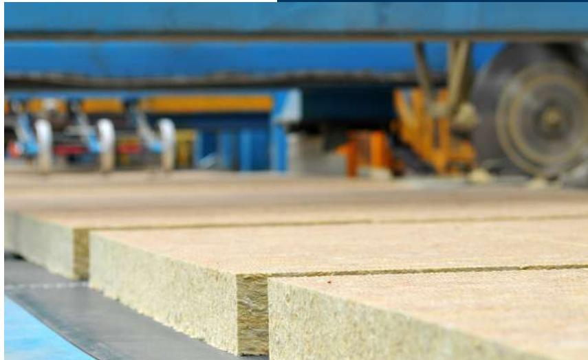
лар) Тошкент шаҳрида «**Akfa insulation**» ҚҚ (йиллик құвваты 30 минг тонна)ларида базалт толасидан иссиқлиқ сақловчы плиталарни ишлаб чиқариш лойиҳалари амалға оширилади.
